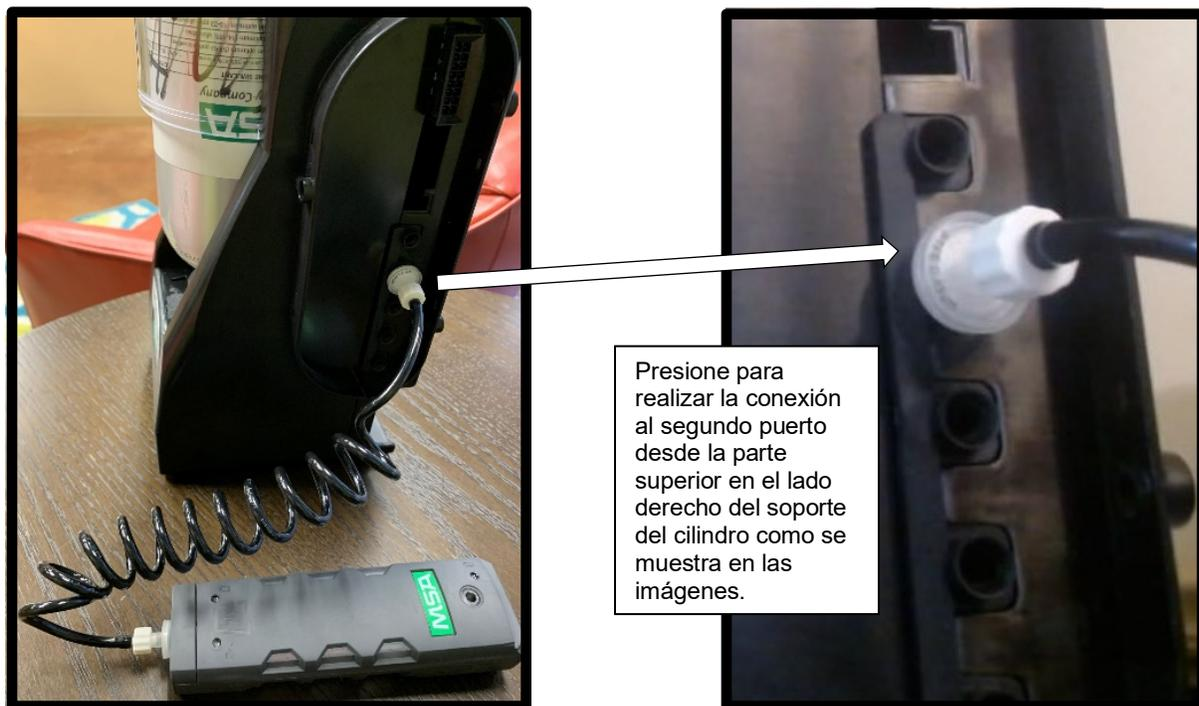
**Figura 6 - Conexión de la sonda de bomba al soporte del cilindro**
