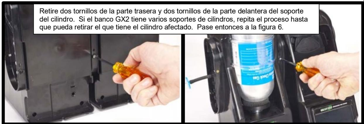
**Figura 5 - Desmontaje de un soporte de cilindros de un banco GX2**
